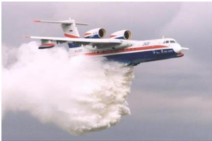
Hydravion russe à réacteurs conçu pour les grandes steppes de Sibérie. Il n'est pas adapté aux reliefs plus accidentés du pourtour méditerranéen. L'inertie de vol due aux réacteurs (plutôt que des turbopropulseurs) le rend difficilement maniable. Des essais réalisés par les pilotes français ont mis en évidence des risques inacceptables liés à cette maniabilité.
