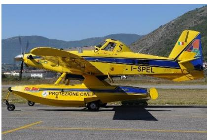
Petit avion pouvant emporter 3000 l d'eau ou de retardant. Cet avion vient plutôt en complément des grands bombardiers d'eau. Il n'est pas adapté aux turbulences des grands feux de forêt où il se comporte de façon très instable.
